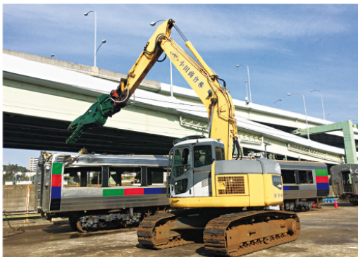
2016年12月6日、JR九州の小倉総合車両センターでステンレス車両(783系)4両に解体に使用された「もうカッターR K2000」。人間交流は、思いもよらぬ副次効果を生み出すと感じた一件でした。
